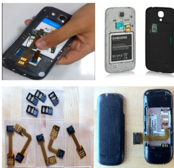
图 5 通过卡槽使用电路扩展的 SIM 卡模块 (来源：百度图片)
